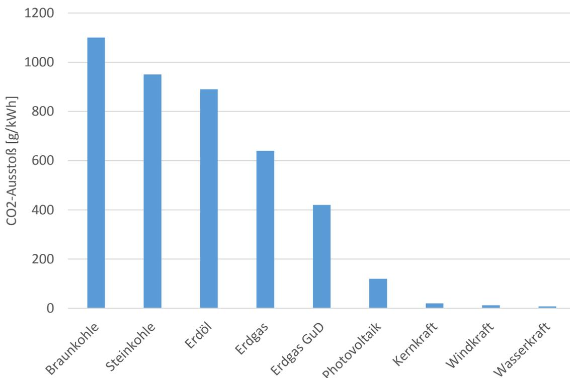
Abbildung 2-2: Durchschnittlicher CO2-Ausstoß je Erzeugungsart nach [20]
