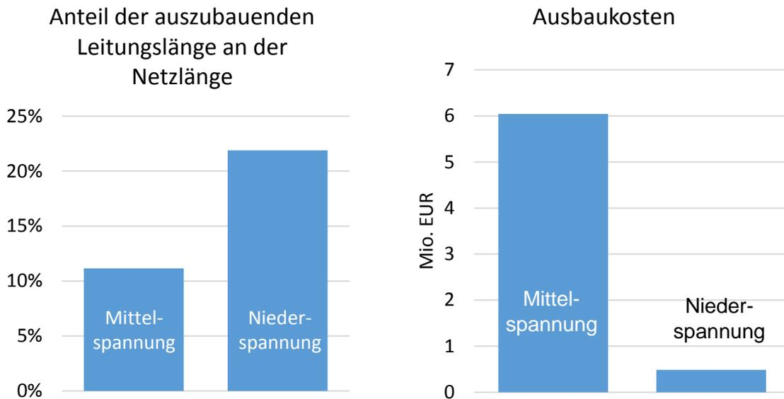
**Abbildung 3-2: Vergleich der Ergebnisse der Netzplanung von Mittel- und Niederspannungsnetzen**
